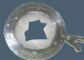
ДИАФРАГМНЫЙ КЛАПАН С КРЕМНИЕВОЙ МЕМБРАНОЙ
