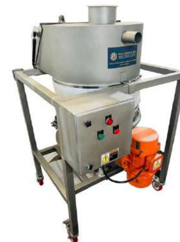
ВНУТРЕННЯЯ СТАНЦИЯ ДЛЯ ВЫГРУЗКИ МЕШКОВ
